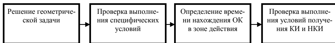
Рис. 3. Блок-схема выполнения задачи обнаружения и сопровождения ОК СМК ВКП
