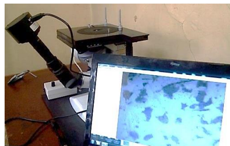
Рис. 1. Цифровое изображение контролируемого сплава, полученное с применением разработанного программного обеспечения
