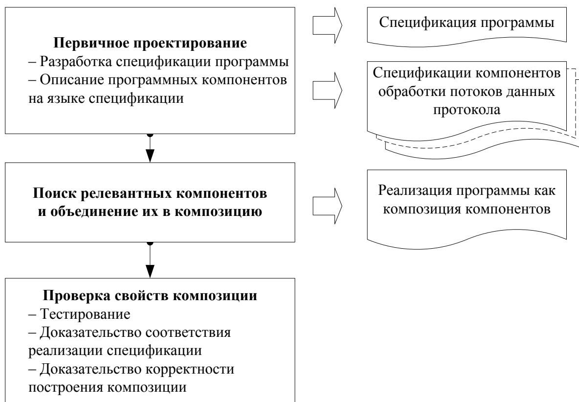
Рис. 1. Общая схема композиционного метода проектирования
