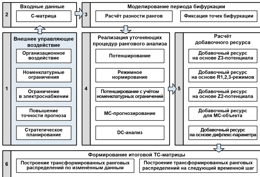
Рис. 6. Структура динамической модели управления электропотреблением
