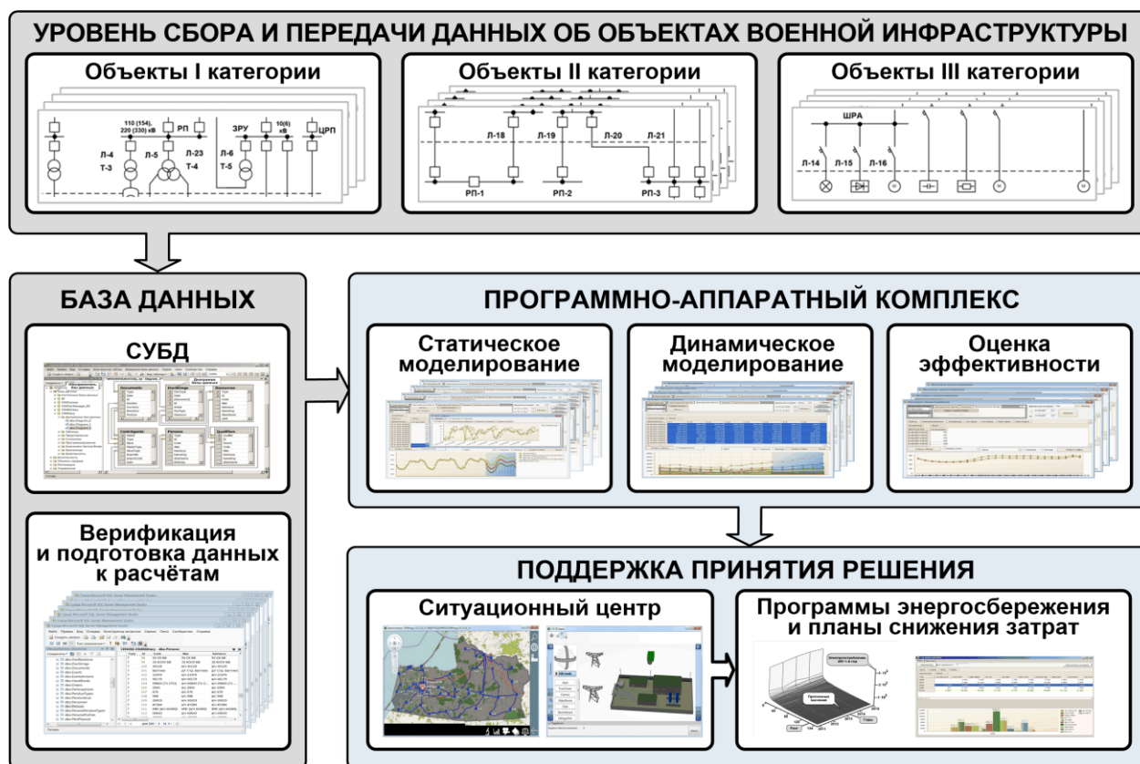
Рис. 2. Структура автоматизированной системы управления электропотреблением при эксплуатации объектов военной инфраструктуры
