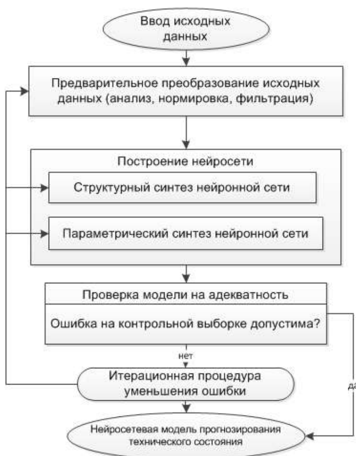
Рис. 2. Общая схема формирования нейросетевой модели
