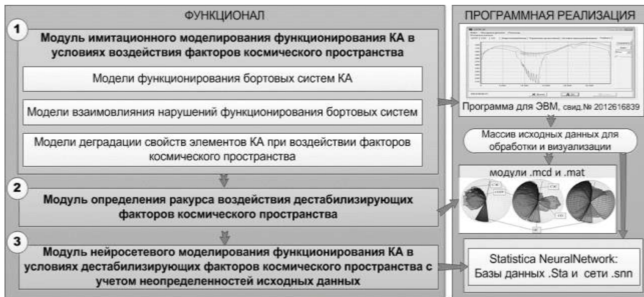
Рис. 1. Структурно-логическая схема программного моделирующего комплекса
