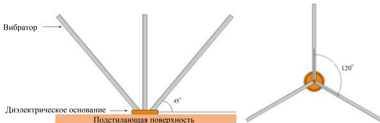
Рис. 4. Предлагаемая модель триортогональной антенны
